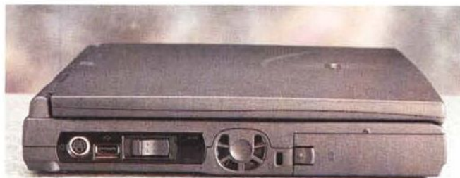
Sul lato sinistro spicca la ventola, per fortuna silenziosissima e quasi sempre ferma. A destra di questa ci sono l'alloggiamento per la batteria e il foro dell'antifurto, alla sinistra il tasto di accensione (a scorrimento), la porta infrarossa, la seriale USB e la porta S-video (standard) per collegare un TVcolor.
